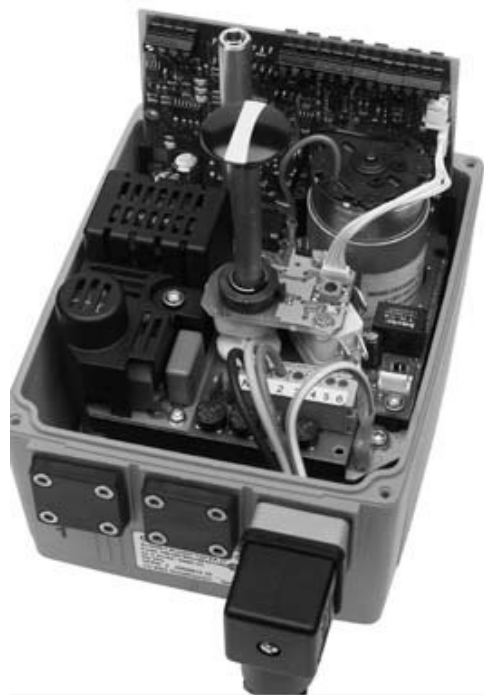
EA 21 mit montiertem Stellungsregler und Positionserfassung.
